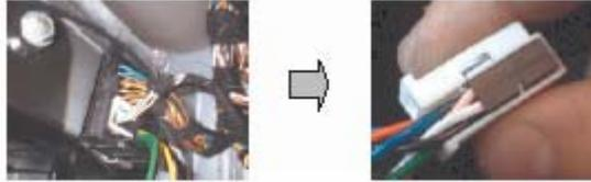
3 – Collegare il connettore nero a 12 PIN al connettore incluso nell'AM-1266. Attenzione a collegare il PIN 1 del connettore maschio al PIN 6 del connettore femmina. I numeri sono stampati sul connettore. Inserire la parte rimanente del connettore 12 PIN dell'AM-1266 dentro la parte libera del connettore MOST. Collegare il MOST all'autoradio..
