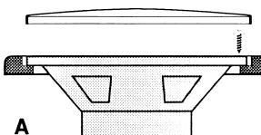
**I** A - montaggio "da sopra" ad incasso con asportazione delle "orecchie" nei cestelli e fissaggio dell'altoparlante tramite mastice o altro con possibilità di protezione tramite le griglie.
