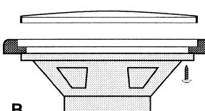
**F** A - montage de l'haut, à encaissement, avec élimination des « oreilles » du saladier. Fixage des haut-parleurs par un mastic ou un produit similaire, avec possibilité de protéger par grilles.
