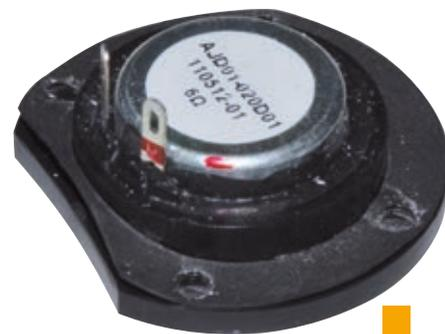
Cupola in seta e microscopico magnete al neodimio per il piccolo 3/4 di pollice. La scheda tecnica segnala l'estensione del tweeter fino a 22 kHz e il taglio con il midwoofer fissato a 3400 Hz. Il crossover del satellite è fissato tipicamente sulla piastra delle connessioni.
