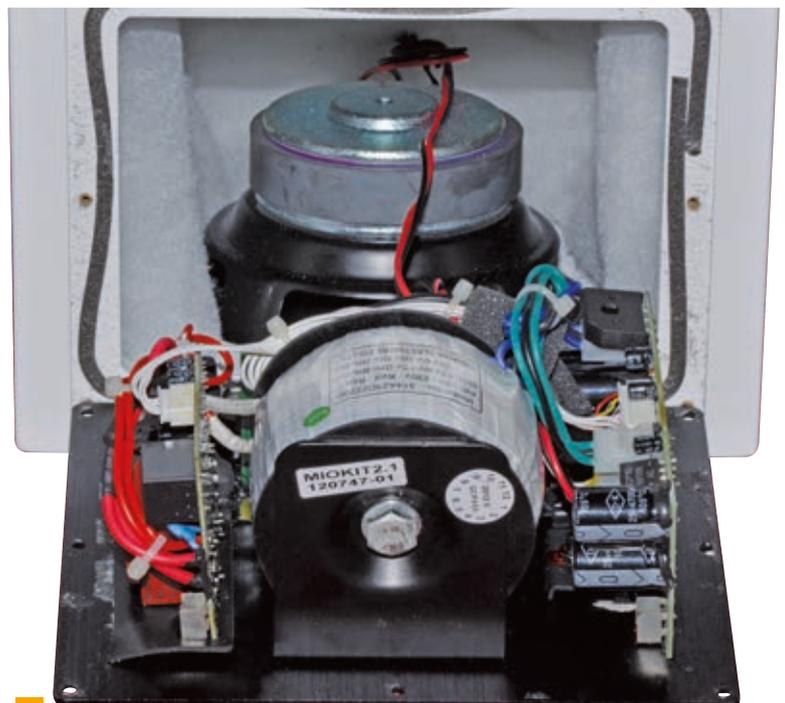
La sezione elettronica del sistema: amplificazione in Classe A/B, con il trasformatore toroidale di buone dimensioni in bella vista. La potenza nominale dichiarata è di 50 watt per il subwoofer e 2x18 watt per i satelliti.
