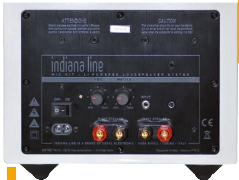
Sulla piastra metallica posteriore al subwoofer ci sono tutti i controlli e in/out del sistema. Da sinistra vaschetta di alimentazione e interruttore; controllo del volume del subwoofer e volume generale; ingresso mini-jack; in basso le due coppie di connettori per gli altoparlanti che accettano sia cavo spellato che banane.
