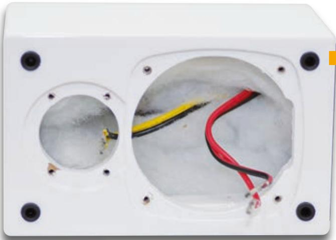
Provando a bussare sulla superficie del box la sensazione è di grande solidità, con un suono sordo come risposta. Merito sicuramente delle sue dimensioni compatte in prima battuta, ma anche del buon spessore del legno utilizzato. Da notare i cavi di diametro sovradimensionato e il volume quasi completamente riempito di materiale fonoassorbente.
