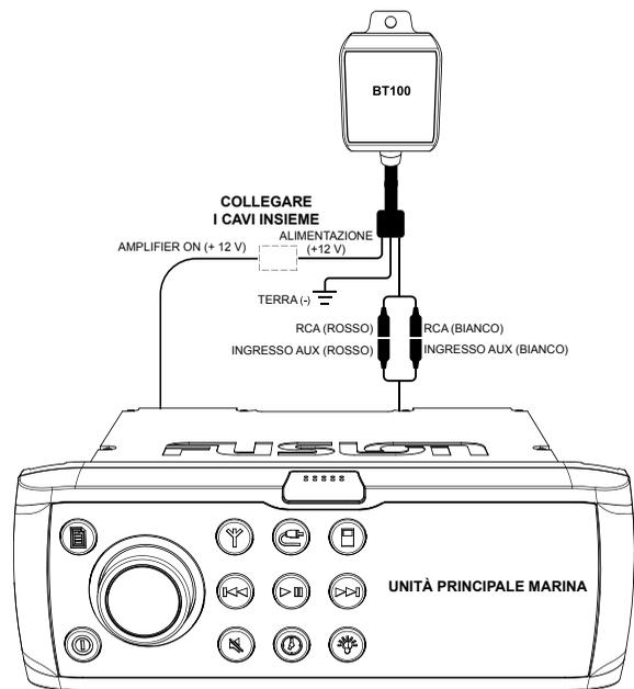
FUSION raccomanda di montare MS-BT100 in posizione elevata, il più lontano possibile da strutture metalliche. In questo modo sarà garantita la portata massima per lo streaming audio Bluetooth. Qualsiasi ostacolo tra MS-BT100 e il dispositivo di streaming ridurrà la portata.
