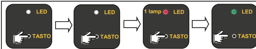
Per resettare la radio ed i tasti, disalimentare UNICOM, premere e tenere premuto il pulsante di UNICOM, alimentare UNICOM fino a che il LED non emette un lampeggio ROSSO, tenere premuto ancora il pulsante fino a che il LED lampeggi velocemente ROSSO.
