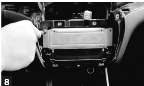
8 Svitare le viti della radio originale e rimuoverla. Lift the screws holding the Original car-radio and remove radio.
