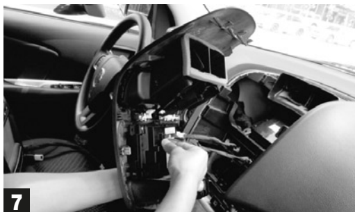
7 Rimuovere il pannello del display e smontare i condotti dell'aria. Remove display-panel and demount the ventilation-ports.
