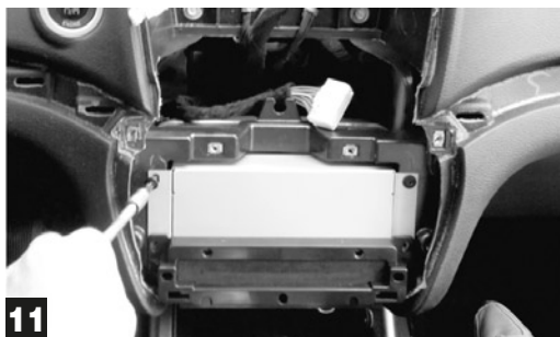
11 Inserire la parte meccanica nel vano e fissarla. Introduce and fix the mechanical part inside the radio-location.
