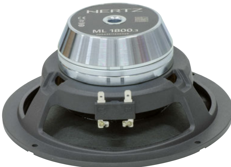
Le dimensioni del gruppo magnetico non sono dissimili da quelle del 6,5 pollici. Da notare, alla base delle tre razze, delle aperture che mettono in comunicazione l'interno del gruppo mobile con l'esterno al fine di assicurare uno scambio di aria. "Basico" il morsetto.
