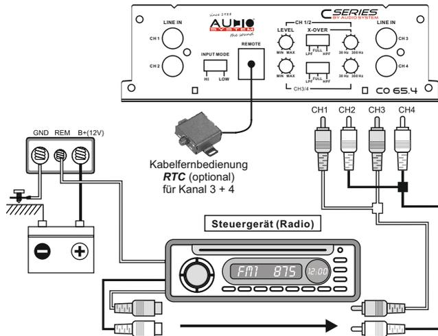
Die C SERIES Verstärker besitzen RCA-Eingänge, welche durch Cinchkabel mit den Vorverstärker-Ausgängen des Steuergerätes verbunden werden. Wenn dies nicht möglich ist (meist bei einem Originalradio, OEM) können die Lautsprecherausgänge des Autoradios direkt auf die RCA/Cinch-Eingänge des Verstärkers angeschlossen werden.
