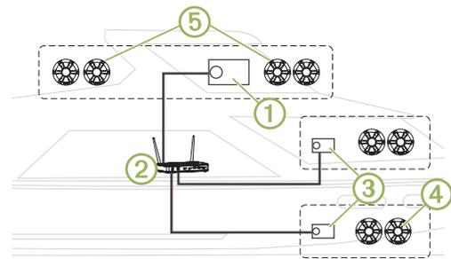
Nell'immagine precedente, uno stereo Apollo RA770 ① è connesso a un router wireless ② e a due stereo a zone Apollo SRX400 ③. I due stereo a zone FUSION PartyBus possono riprodurre in streaming le sorgenti dello stereo FUSION PartyBus.
