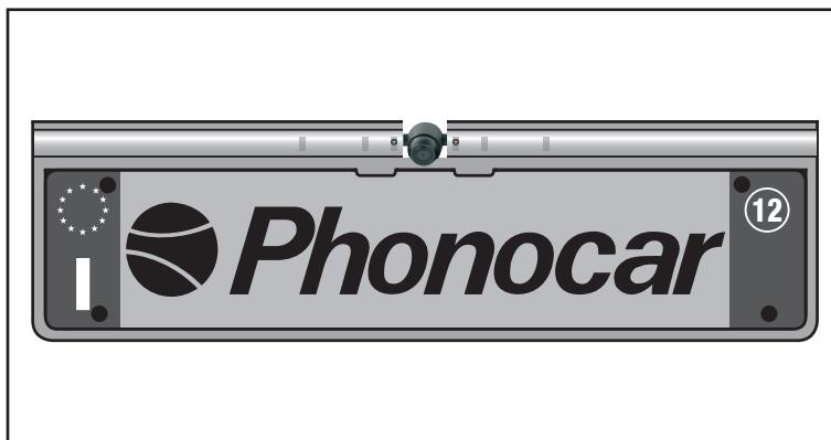
**I** - Installare la targa tramite le boccole fornite in dotazione.
