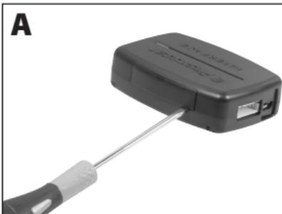
Les interrupteurs pour le réglage de la voiture et de l'autoradio se trouvent sous la trappe.
