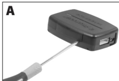
Debajo de la tapa están presentes una serie de micro switch que sirven para configurar la centralita según el coche y el autorradio. Seguir el esquema para la configuración del modelo de vehículo y además para configurar la marca de la autorradio.
