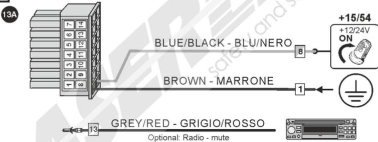
**Connessione speciale solo con modulo Wi-Fi a 12Volt
