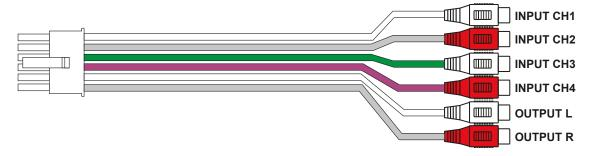
Falls Ihr Steuergerät keine Cinch-Vorverstärker-Ausgänge besitzt, können Sie die Hochpegeleingänge des Verstärkers als Signaleingang verwenden. Vergewissern Sie sich, dass der Tastschalter **INPUT LEVEL (#7)** sich in der Stellung **HIGH** (gedrückt) befindet. Schließen Sie dazu die Lautsprecherkabel des Steuergeräts wie folgt an den beiliegenden Kabelstecker an:
