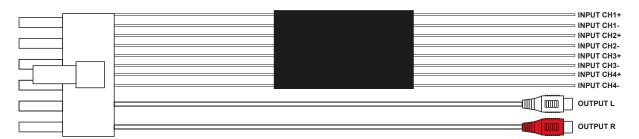
Die **OUTPUT** Cinch-Ausgänge beider beiliegenden Kabelstecker liefern ein lineares Vollbereichs-Audiosignal für die Ansteuerung weiterer Verstärker.
