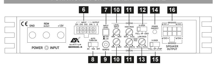
Die **INPUT** Cinch-Eingänge des beiliegenden Kabelsteckers zur Ansteuerung mittels Cinch-Audiokabel mit dem Steuergerät verbinden. Vergewissern Sie sich, dass der Tastschalter **INPUT LEVEL (#7)** sich in der Stellung **LOW** (nicht gedrückt) befindet.
