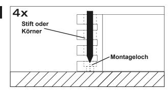
Belassen Sie dann den Prozessor an der gewünschten Einbaustelle im Fahrzeug. Markieren Sie die vier Bohrlöcher durch das jeweilige Montageloch an den Gussendteilen mit einem geeigneten Stift oder Körner.
