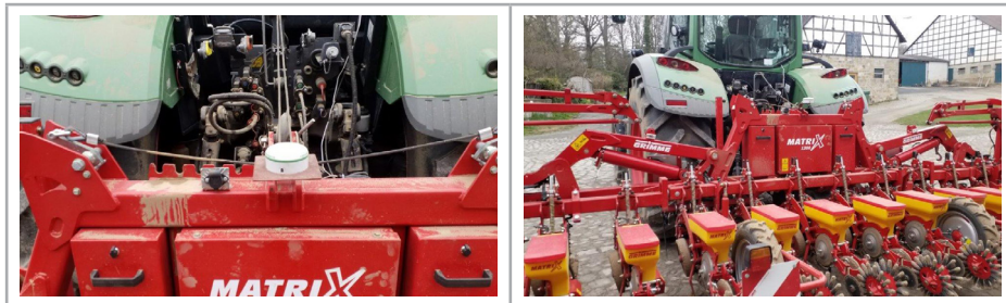
Figura 1.3.3.b - Esempi di installazione del ricevitore al centro della seminatrice
