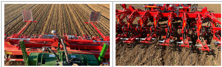
Figura 1.3.3.d - Esempi di installazione del ricevitore al centro della sarchiatrice
